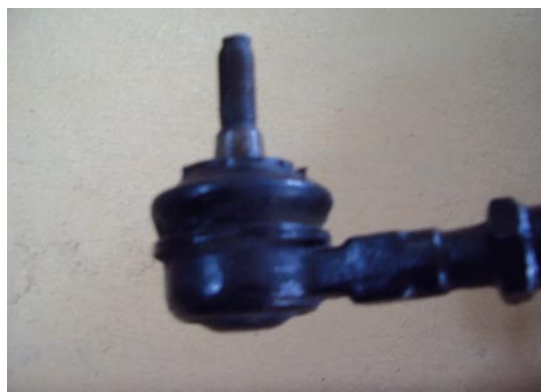
6.3 pav. Lankstų gaubtų tikrinimas
