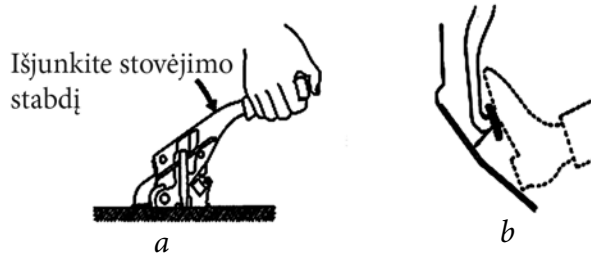
6.25 pav. Stabdžių pedalo eigos atsargos tikrinimas: a – stovėjimo stabdžio išjungimas; b – pedalo eigos atsarga
