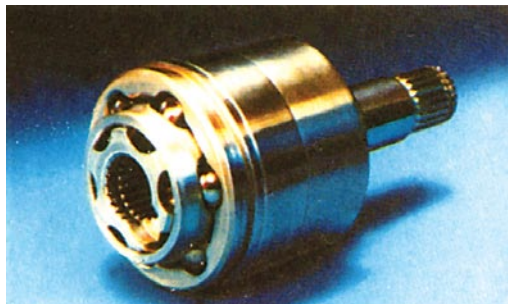
5.10 pav. Lygių kampinių greičių slankusis universalus GKN tipo lankstas
