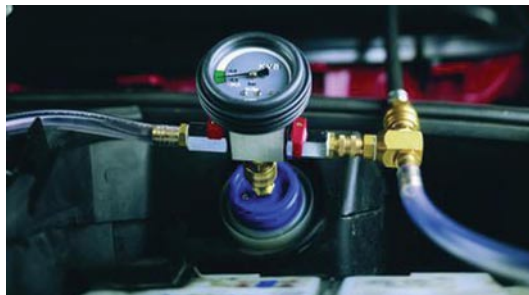
2.9 pav. Oro iš aušinimo sistemos šalinimo prietaisas KVB
