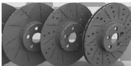
3.22 pav. Modifikuoti stabdžių diskai
