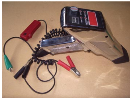
3.31 pav. Uždegimo kampo nustatymas stroboskopu: a – stroboskopas be uždegimo kampo matavimo įtaiso; b – stroboskopas su uždegimo kampo matavimo įtaisu (kartu gali būti tachometro, kontaktų uždaro būklės kampo matavimo ir voltmetro funkcijos)
