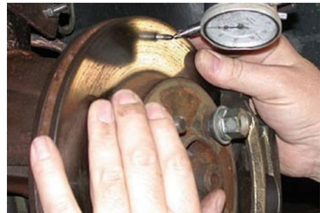
6.19 pav. Stabdžių disko mušimo tikrinimas
