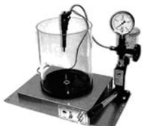
2.51 pav. Common Rail purkštuvų tikrinimo stendas
