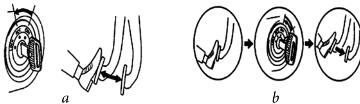
6.30 pav. Stabdžių stiprintuvo darbo patikrinimas: a – išjungus variklį; b – varikliui veikiant
