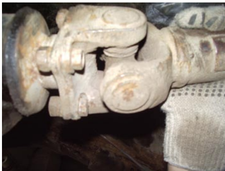
4.10 pav. Lankstų laisvumo tikrinimas
