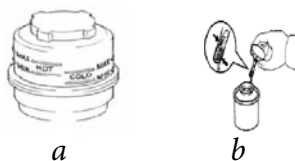
6.7 pav. Vairo stiprintuvo alyvos lygio patikrinimo būdai: a – bakelis su alyvos lygio žymėmis; b – alyvos matavimas matuokliu
