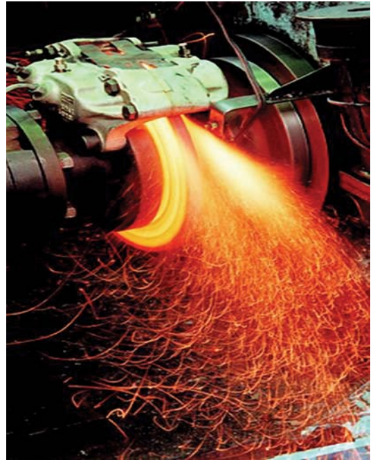
3.6 pav. Stabdžių disko įšilimas
