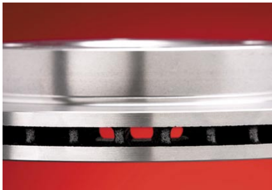
3.20 pav. Stabdžių diskas su papildomomis oro aušinimo ertmėmis
