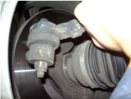
6.2 pav. Vairo trauklių lankstų laisvumo tikrinimas
