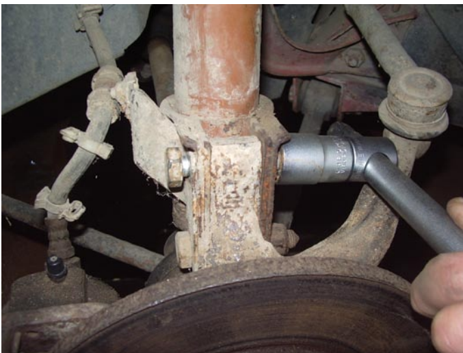
5.2 pav. Amortizatorių tikrinimas: a – užveržimo, b – atraminio guolio
