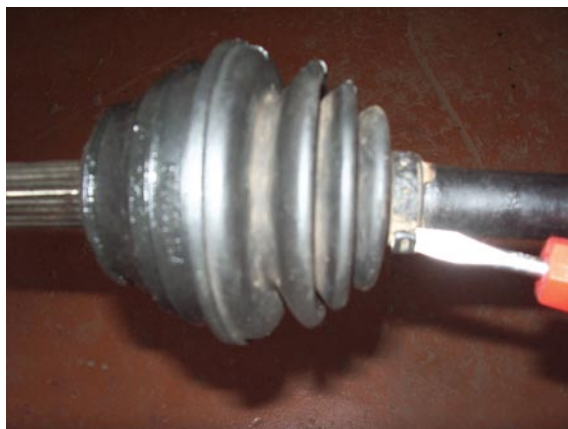
4.14 pav. Apsauginių gaubtų ir užvaržų tikrinimas
