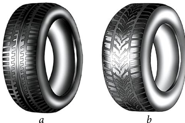
1.56 pav. Skirtingų padangų protektoriaus piešinys: a – vasarinė padanga; b – žieminė padanga
