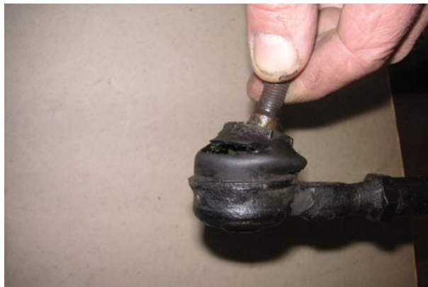
6.3 pav. Lankstų gaubtų tikrinimas
