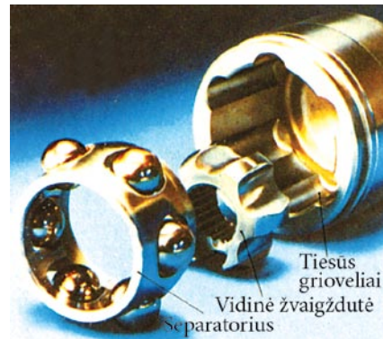
5.10 pav. Lygių kampinių greičių slankusis universalus GKN tipo lankstas
