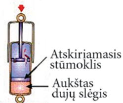
1.24 pav. Dujinis vienvamzdis amortizatorius
