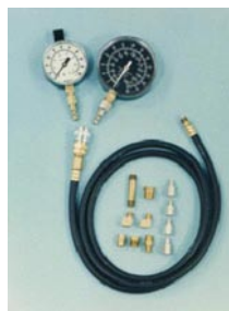
2.14 pav. Alyvos slėgio tikrinimo manometras
