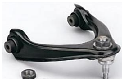
1.25 pav. Trikampė svirtis su trimis atramos taškais
