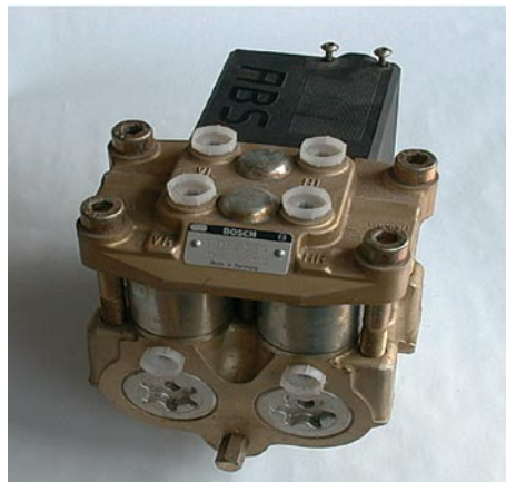
3.56 pav. Firmos BOSCH hidraulinio agregato – moduliatoriaus – blokas su trijų padėčių elektromagnetiniais vožtuvais
