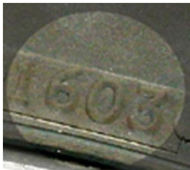
1.63 pav. Pagaminimo datos žymėjimas ant padangos
